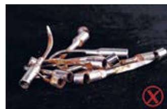
Насадка неизвестного китайского производителя через 1 час работы. Через 10 часов работы 35% насадок выходят из строя
