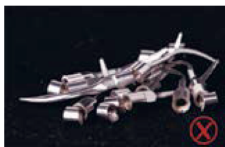
Насадка неизвестного китайского производителя после 6 минут работы с пациентом после качественного процесса стерилизации
